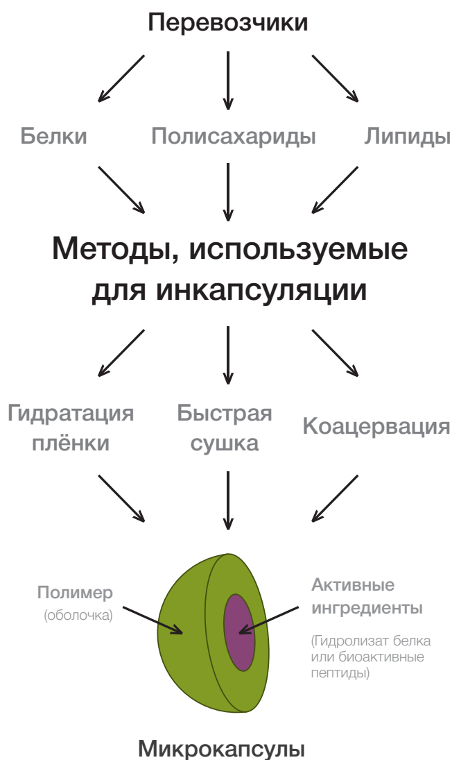
Рис. 2 Принципиальная схема инкапсуляции биопептидов
